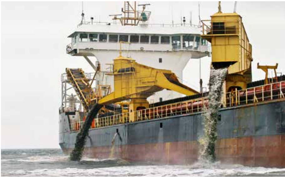
Ein Sand- und Kiesförderschiff pumpt Wasser zurück in die Nordsee. Sand und Kies bleiben an Bord.
